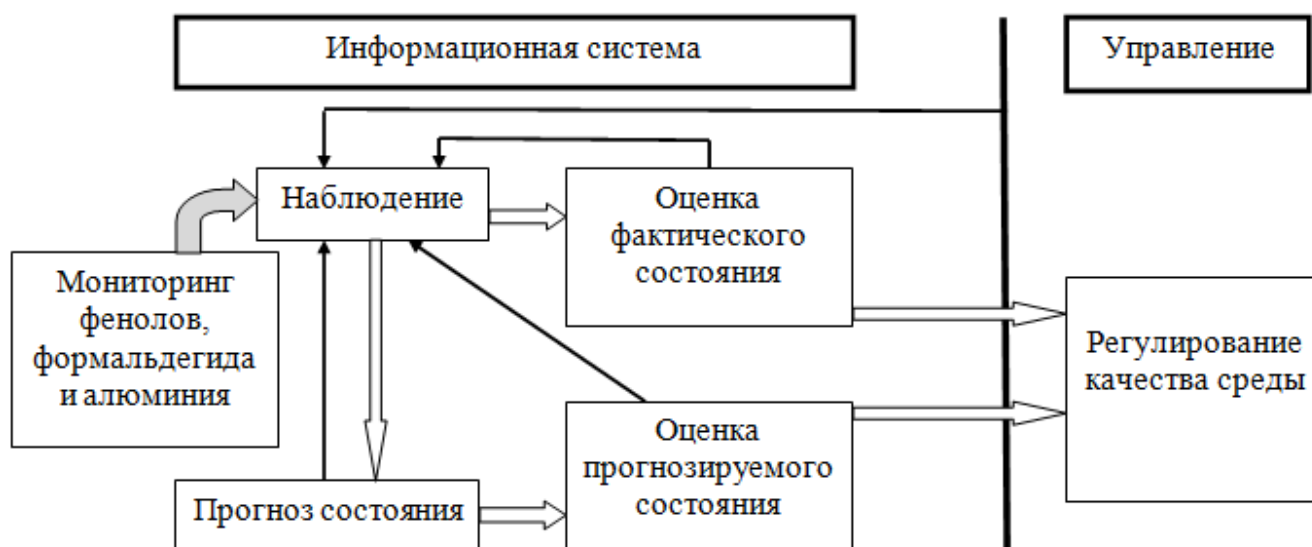
Рисунок 5.3 – Место гидрохимического мониторинга фенолов, формальдегида и алюминия (III) в экологическом контроле (по Ю. А. Израэлю [134])
