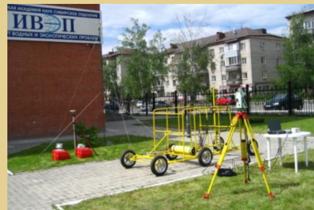
Рис. 2. Мобильный аппаратный комплекс для мониторинга береговой зоны
